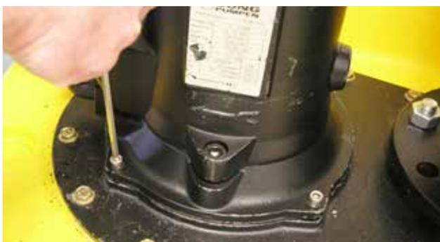
▶ Einfaches Lösen der Pumpeinheit
