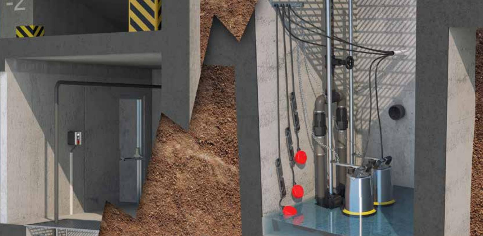
**Double protection thermique moteur** - elle arrête la pompe dès que le moteur atteint une température critique
