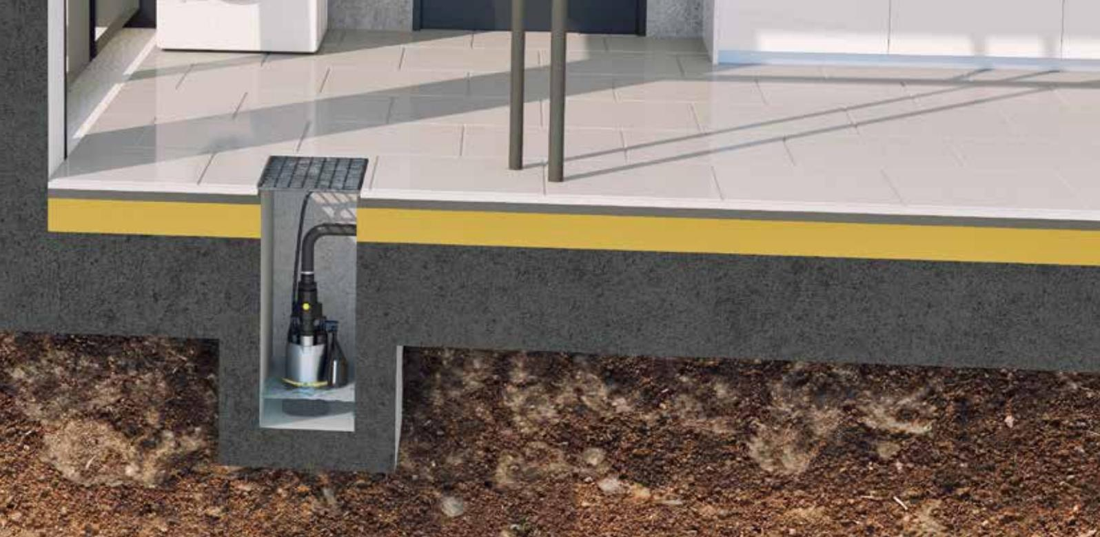
**Multidrain UV3 SE** avec flotteur fermé - idéal pour les regards étroits à partir de  $\varnothing$  22 cm
