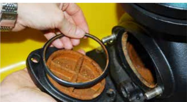
▶ Vérification et nettoyage du clapet antiretour
