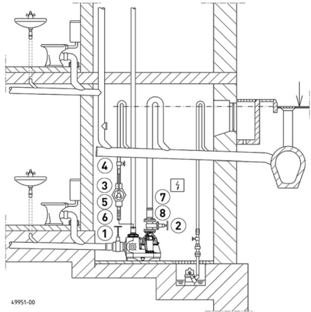
maintenance. La conduite de refoulement doit être dirigée au-dessus du niveau de retenue observé sur place et il est nécessaire de monter un clapet anti-retour certifié selon EN 12050-4. Il est nécessaire de diriger le conduit d'aération au-dessus du niveau du toit selon EN 12056.
