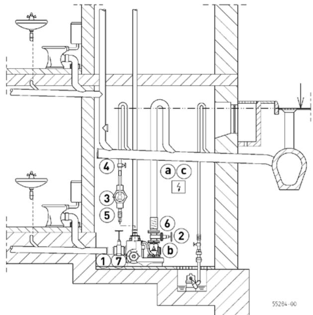
Die Anlagen haben einen Anschlussflansch DN 80/PN 10, jedoch mit Rohrstützen DN 100. Bei direktem Aufbau brauchen Rückschlagklappen und Absperrschieber deshalb nur in DN 80 gewählt werden. Die weiterführende Druckleitung wird mit DN 100 durch die elastische Verbindung angeschlossen. Fäkalienhebeanlagen sind nach den Bau- und Prüfgrundsätzen der EN 12050 zur Förderung von Fäkalien und häuslichem Abwasser (EN 12056, DIN 1986-3) in der Gebäudeentwässerung
