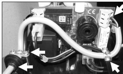
Alarmowy przewód przyłączeniowy wprowadzony jest do obudowy pompy kondensatu równolegle do przewodu sieciowego. W tym celu należy otworzyć drugi otwór w przepuszcze kablowym.
