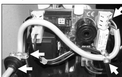
A riasztási csatlakozóvezetéket a hálózati vezetékkal párhuzamosan kell elvezetni a kondenzátszivattyú foglalatában. Ehhez az átvezetési tokon lévő második nyílást is meg kell nyitni.
