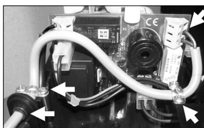
Le câble de raccordement de l'alarme est dirigé dans le boîtier de la pompe à condensats de façon parallèle au câble d'alimentation. Pour ce faire, il est nécessaire d'ouvrir la seconde ouverture dans le passe-câbles.
