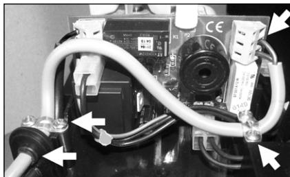
Die Alarm-Anschlussleitung wird parallel zur Netzeleitung in das Gehäuse der Kondensatpumpe geführt. Hierzu muss die zweite Öffnung in der Durchführungsstüle geöffnet werden.
