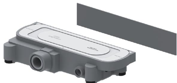
Bei freistehender Montage beiliegende Dämmplatte auf die Rückwand kleben. Die vier Füße unten in den Behälter montieren und das Gerät in der Höhe sowie waagerecht ausrichten.
