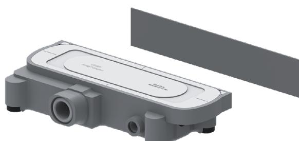
W przypadku instalacji wolnostojącej należy przykleić dołączoną płytę izolacyjną do tylnej ściany. Zamontować cztery nóżki w dolnej części pojemnika i wyrównać urządzenie w pionie i poziomie.
