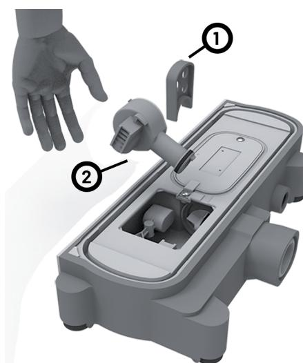
Sollte die Hydraulik verstopft sein, ziehen Sie die rote Fixierung nach oben heraus. Dann lockern Sie vorsichtig die Hydraulik und nehmen sie heraus. Nach der Reinigung achten Sie beim Wiedereinbau darauf, dass die Rückschlagklappe und die Dichtung richtig sitzen. Um die Montage zu erleichtern, sollten die beiden Dichtringe vor der Montage mit etwas Schmiermittel versehen werden. Zum Schluss wird die rote Fixierung eingesetzt.
