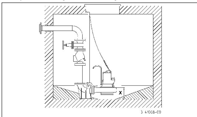
**Montage:** Cheviller fermement le pied d'assise au fond de la chambre collectrice, puis monter les tubes de glissement. Ensuite, installer la conduite de refoulement y compris les accessoires de tuyauterie tels que le clapet anti-retour et la vanne d'arrêt.
