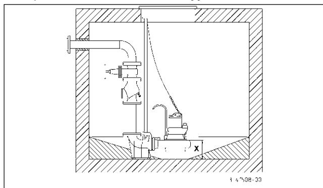
**Montaggio:** Ancorare saldamente il piede di accoppiamento al suolo del pozzo di raccolta e quindi montare le guide. Collegare il tubo di mandata con le dotazioni necessarie, valvole di ritorno e valvola a saracinesca.
