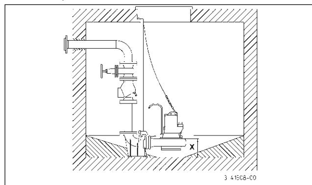
**Montage:** Den Kupplungsfuß fest auf dem Boden des Sammelschaches verdübeln und dann die Gleitrohre montieren. Dann die Druckleitung einschließlich der erforderlichen Armaturen wie Rückschlagklappe und Absperrschieber einbauen.
