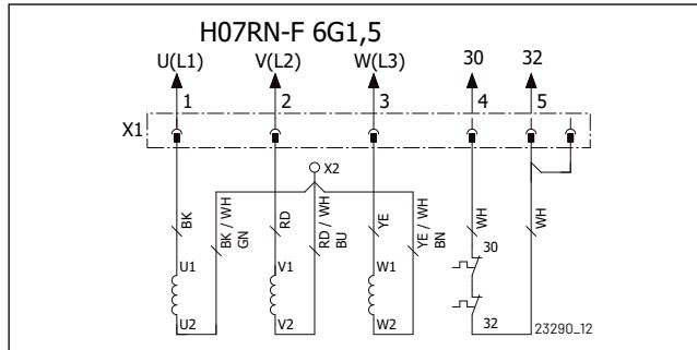
Le modifiche ai circuiti devono essere apportate utilizzando connettori a compressione (X) tra il connettore a cono (Y) e il motore integrato. I connettori a compressione nuovi devono essere prodotti secondo lo stato dell'arte.
