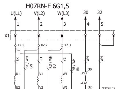
Y-Zapojenie, vysoké napätie
