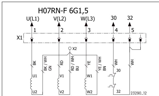
Alterações nos circuitos devem ser feitas usando conectores de aperto „Crimp” (X) entre a conexão do plugue cônico (Y) e o motor embutido. A nova conexão deve ser feita profissionalmente.
