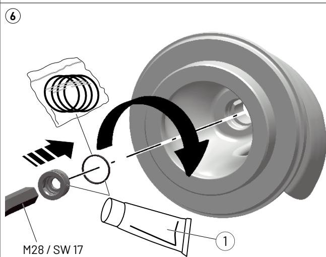
1 Montagepaste, Assembly paste, Pâte de montage, Montagepasta, Pasta de montagem, Pasta di montaggio, Pasta montażowa, Montážní pasta, Montážna pasta, Szerelőpaszta, Pastă de asamblare
