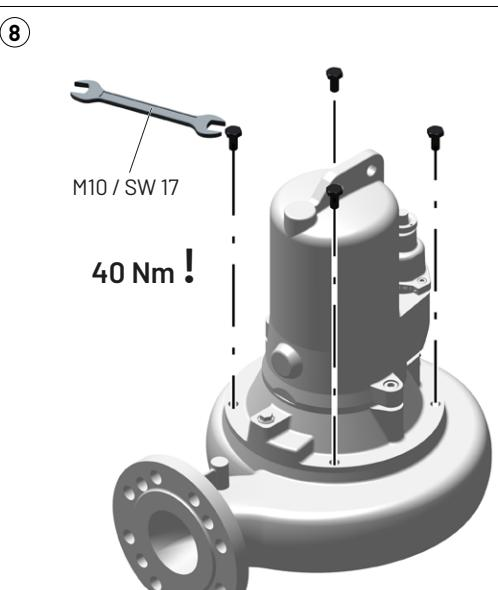
Kanalrad-Spalt einstellen | Adjust the impeller gap | Réglage de la fente de la roue de pompe | Instellen van de centrifugaalwaaierspleet | Ajustar a folga do impulsor | Impostazione del gioco della girante a canali | Regulacja luzu wirnika kanałowego | Seřízení mezery kanálového kola | Nastavenie štrbiny rozvádzacieho kolesa | Az csatornakerék résének beállítása | Reglarea fantei rotorului cu ajutaj
