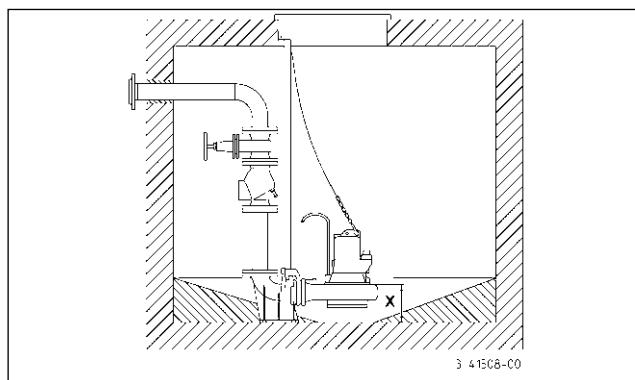
**Montáž:** Nohu spojky pomocou hmoždiniek upevnite na dne zbernej šachty a potom namontujte klzné rúrky. Potom zbudujte výtláčné potrubie vrátane potrebných armatúr ako je spätná klapka a posúvač.
