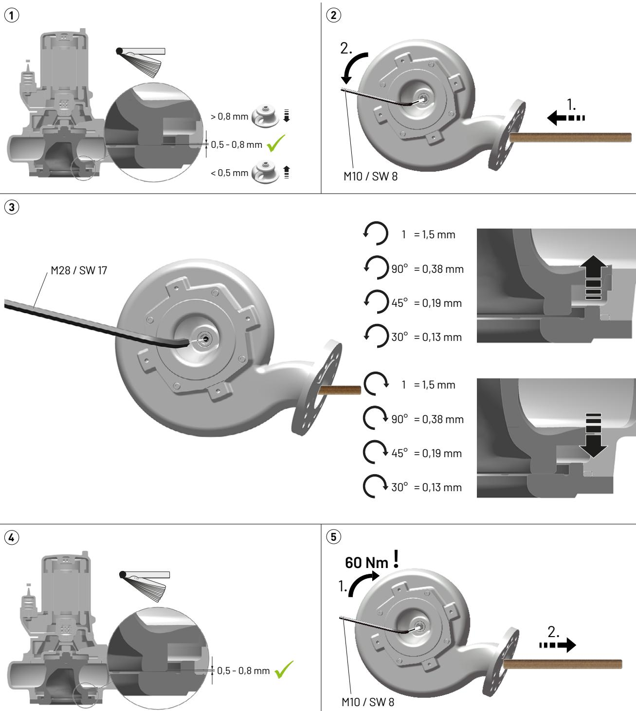
**Kanalrad / Laufrad auswechseln | Replacing the impeller | Remplacement de la roue de pompe | Vervanging van de waaier | Substituir o impulsor | Sostituzione della girante | Wymiana wirnika | Výměna oběžného kola | Výmena obežného kolesa | Az futókerekek cseréje | Schimbarea rotorului**
