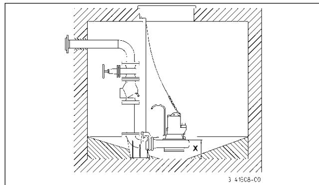
**Montage:** De koppelingsvoet stevig met pluggen op de bodem van de verzamelpot vastzetten en vervolgens de schuivende buizen monteren. Vervolgens de drukleiding met de nodige hulpstukken zoals terugslagklep en afsluiter monteren.
