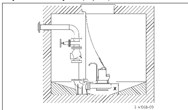
**Montaż:** Przymocować kotwami stopę łączącą na posadzce studni kolektorowej i następnie założyć rurę styczną. Następnie dokonać montażu rurociągu ciśnieniowego, włącznie z niezbędną armaturą jak klapy zwrotnie i zasuwy odcinające.
