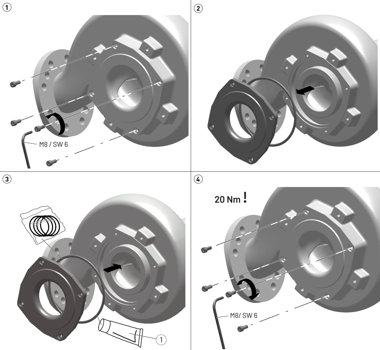
Kanalrad-Spalt einstellen | Adjust the impeller gap | Réglage de la fente de la roue de pompe | Instellen van de centrifugaalwaaierspleet | Ajustar a folga do impulsor | Impostazione del gioco della girante a canali | Regulacja luzu wirnika kanałowego | Seřízení mezery kanálového kola | Nastavenie štrbiny rozvádzacieho kolesa | Az csatornakerék résének beállítása | Reglarea fantei rotorului cu ajutaj
