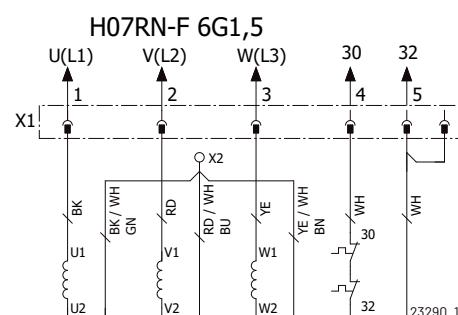
Zmeny zapojenia je možné vykonať len s použitím skrutkových spojok(X). Skrutkové spojenie musí byť vykonané odborne.
