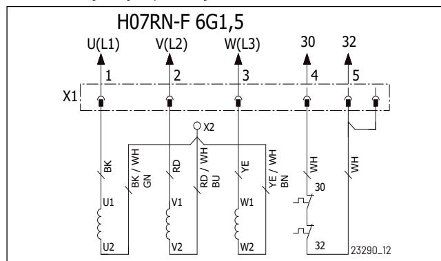
Schakelingswijzigingen moeten worden uitgevoerd met gebruikmaking van knelverbindingen (X) tussen de Coni-aansluiting (Y) en de inbouwmotor. De nieuwe knelverbinding moet professioneel worden aangebracht.
