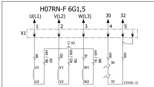
Wykonanie zmian przyłączy należy przeprowadzić przy zastosowaniu połączeń zaciskowych (X). Nowe połączenie zaciskowe należy wykonać w sposób fachowy.
