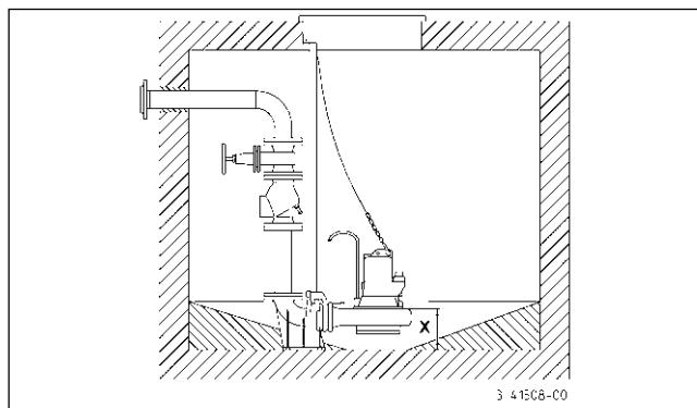
**Beszerezés:** Erősítse fel a csatlakozót a gyűjtőakna padlójára, majd szerelje fel a vezetőcsövet! Azután építse be a nyomóvezetéket a szükséges armatúrákkal (például visszacsapószelep, tolózár) együtt.
