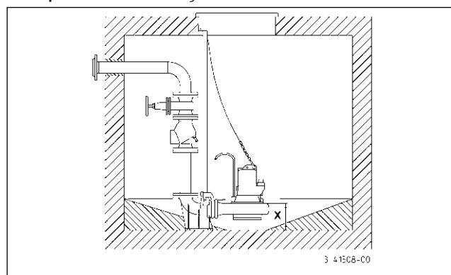
**Montaj:** Prindeți cu dibluri piciorul cuplajului de fundul puțului colector și montați apoi glisierele. După aceea montați conducta de alimentare inclusiv armaturile necesare ca supapa fluture și ventilul de închidere.
