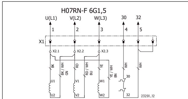
Y-Przełączanie, wysokie napięcie
