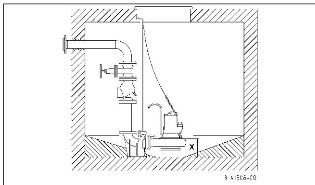
**Montagem:** Fixe firmemente a base do acoplamento no chão da câmara de coleta e, em seguida, monte os trilhos de guia. Em seguida, instale o tubo de pressão, incluindo os acessórios necessários, como a válvula de retenção e as válvulas de corte. Por fim, instale a bomba com a trava de acoplamento aparafusada nos trilhos de guia e baixe-a para o lugar usando uma corrente presa à pega.
