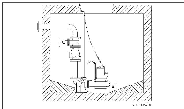
**Montáž:** Patku spojky připevnit hmoždinkami na dnu sběrné šachty a potom namontovat posuvnou trubku. Potom zamontovat tlakové potrubí včetně potřebných armatur, jako je zpětná klapka a uzavírací šoupátko.
